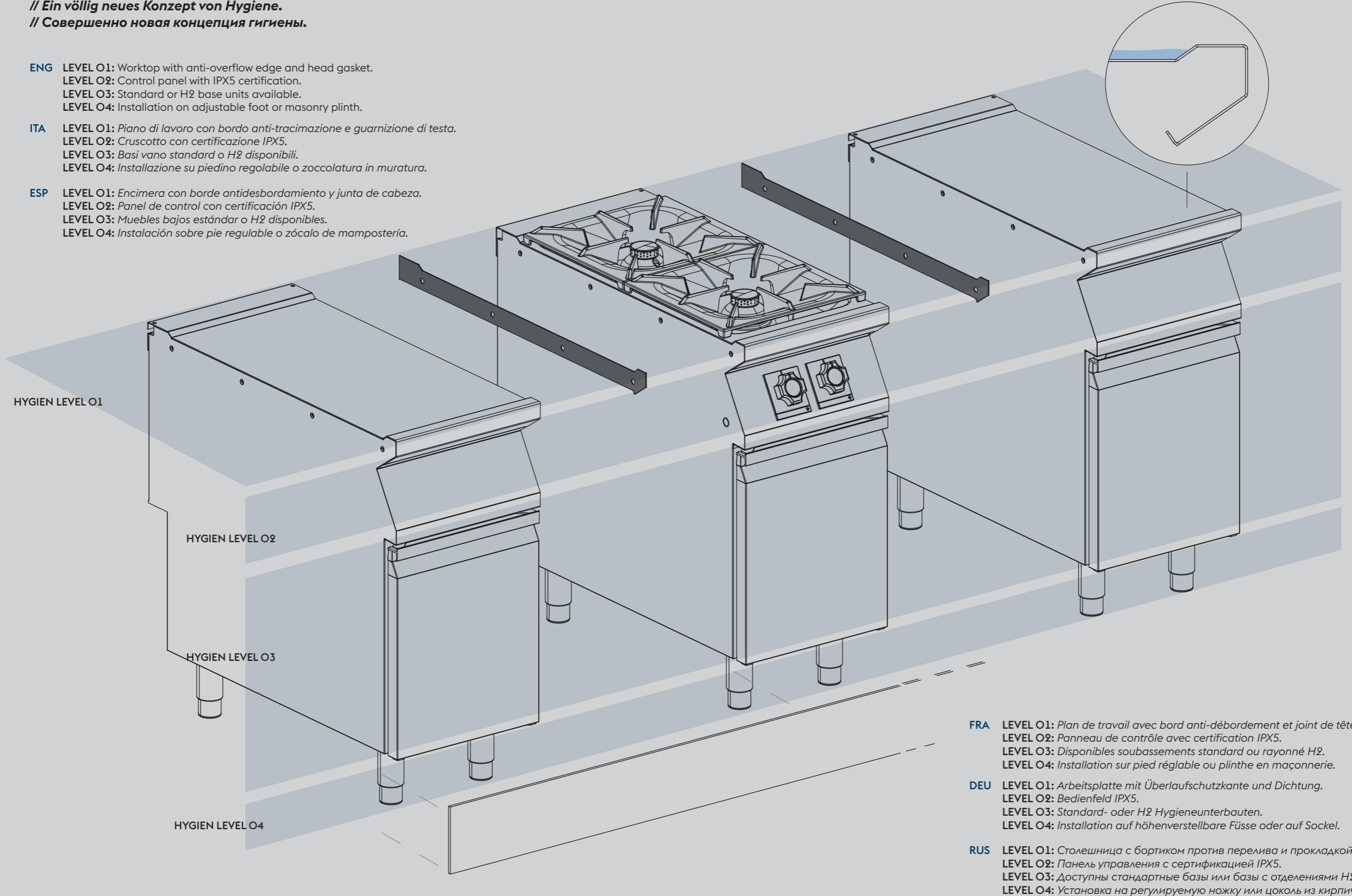
**FRA** LEVEL O1: Plan de travail avec bord anti-débordement et joint de tête.
